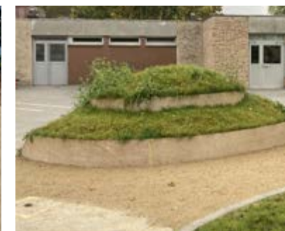
Réutilisation sur site de la terre de déblais en butte plantée. École de la Justice, Cergy
